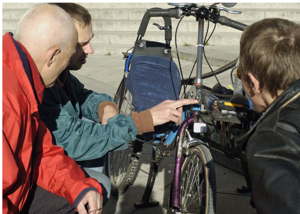
Här visar Mikael Blyborg hur kedjan länkats för att inte interferera med styrningen.
